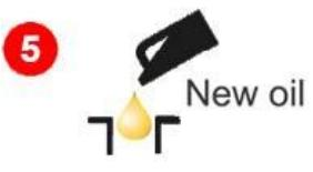
Если после обработки в масляной системе упало давление, необходимо заменить масляный фильтр. Если первая обработка проводится на старом масле, то перед второй обработкой провести замену масла и масляного фильтра.
